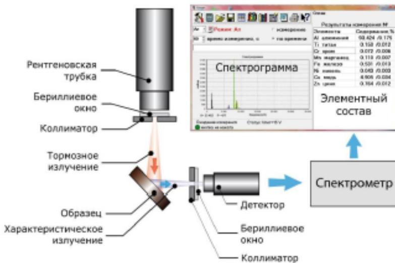
При расчете используется метод фундаментальных параметров, не требующий эталонных образцов для точного определения в исследуемых объектах массовой доли любых элементов в любых концентрациях.
