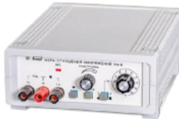
Мера отношения напряжений Н4-8 предназначена для определения линейности основных пределов вольтметров, аналого-цифровых преобразователей (АЦП), делителей и т.п., а также для расширения диапазона однозначных мер напряжения из.д.с. Основу прибора составляет резистивная декада (десять последовательно соединенных равноточи-
