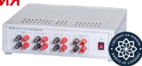
Мера сопротивления Н4-12МС с номинальными значениями сопротивлений 100, 10, 1 и 0,01 Ом изготовлена на основе прецизионных резисторов с низкой температурной зависимостью и очень малой частотной погрешностью. Технологические и конструктивные решения изготовления мер сопротивления обеспечивают сохранение частотных характеристик в течение всего срока эксплуатации.
